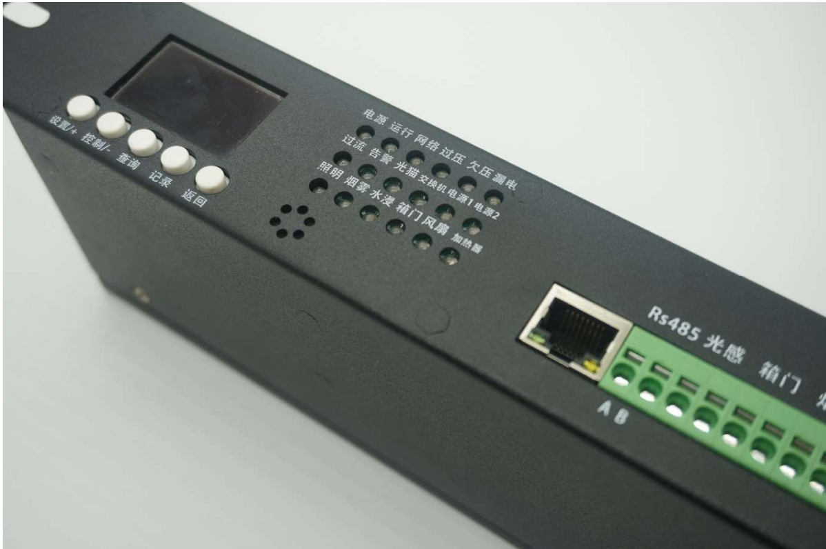
图表 2 液晶屏、指示灯、网口、串口、光感输入
